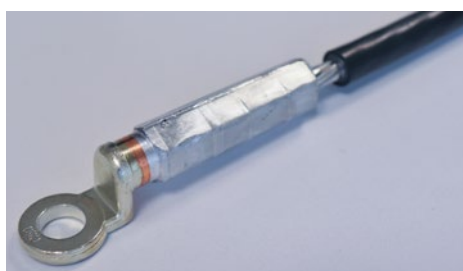
ケーブル圧縮後
